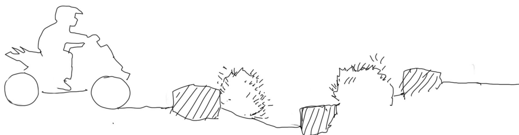
Enrochement, plantation et travail de nivellement pour obstacle à engin motorisé
